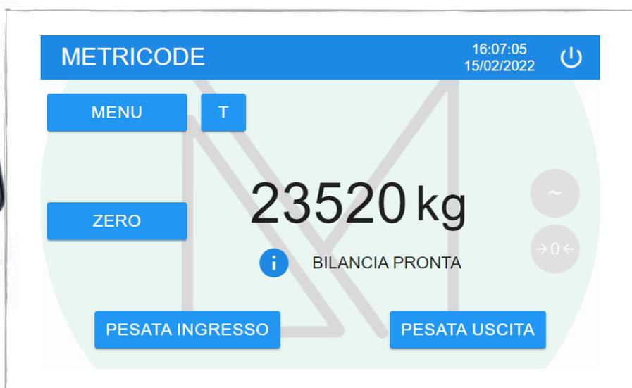
WeightIT EASY è il software che semplifica la gestione delle pesate in ingresso/ uscita sulla pesa a ponte tramite l'utilizzo di un display touch
